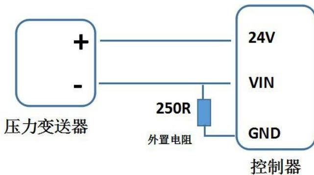
如果控制器内置有电阻 可以将 VIN 和 RA1 端子短接。
