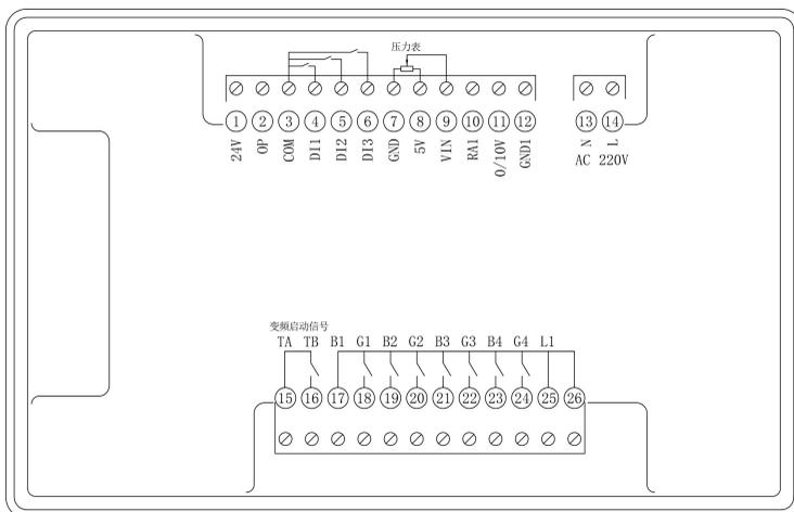
压力变送器接线:
